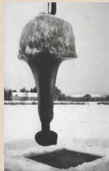
Испытание воздушных замораживающих установок на озере Круглом в г. Якутске
