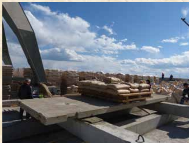
Производственная площадка АО ПО «Якутцемент». Постановочные испытания на трещиностойкость железобетонных предварительно напряжённых аэродромных плит типа ПАГ-14 (Якутск, 2017 г.)
