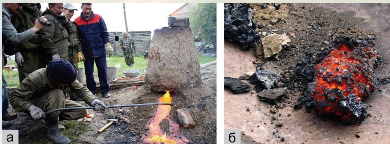
Рис. 1. Опытная плавка кричного железа: а – слив шлака; б – неостывшая крица [8]
