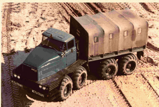
Автомобильный вездеход «НАМИ-0127» типа 8x8 грузоподъемностью 7,0 т
