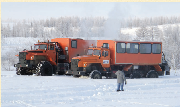
Тестовые заезды вездеходов «Урал-Полярник» на снегоболотоходных колесах (28,1R26) шириной до 750 мм, диаметром до 1700 мм и дорожных от базового автомобиля «Урал» (14,00/20)
