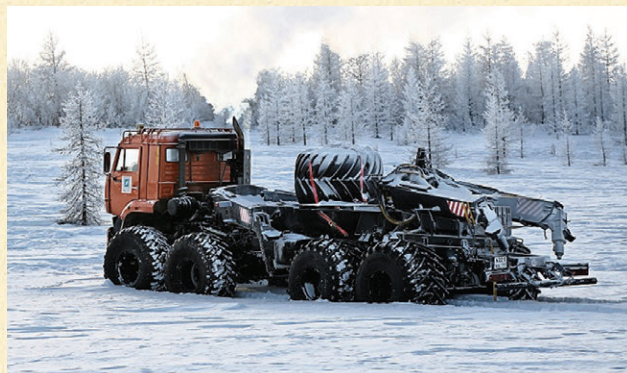
Тестовый заезд вездехода «КамАЗ-Полярник» на снегоболотоходных колесах с шинами шириной до 1100 мм и диаметром до 1650 мм среднего и заднего мостов и соответственно до 750 мм и до 1700 мм – передних мостов
