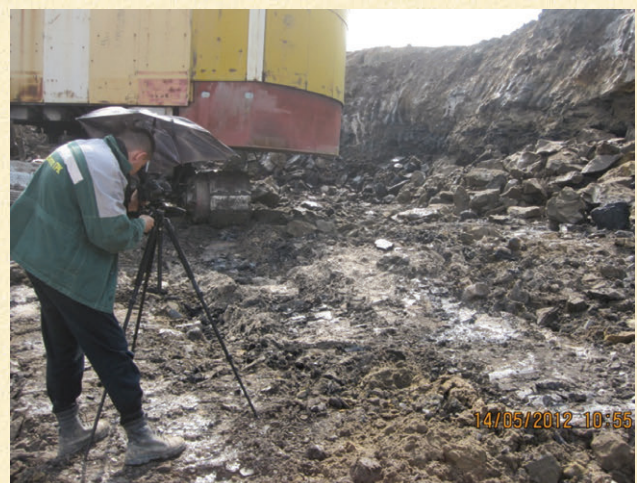
Рис. 6. Термографическая съемка забоя драглайна 1 на руднике «Кангаласском»
