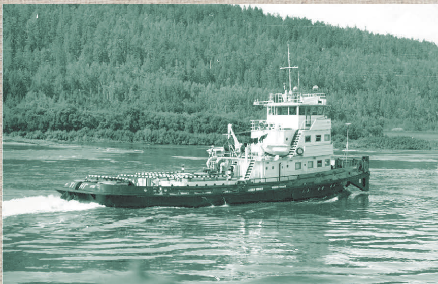
Буксир мощностью 1100 л. с., построенный в Киренске по замыслу И. А. Дмитриева
