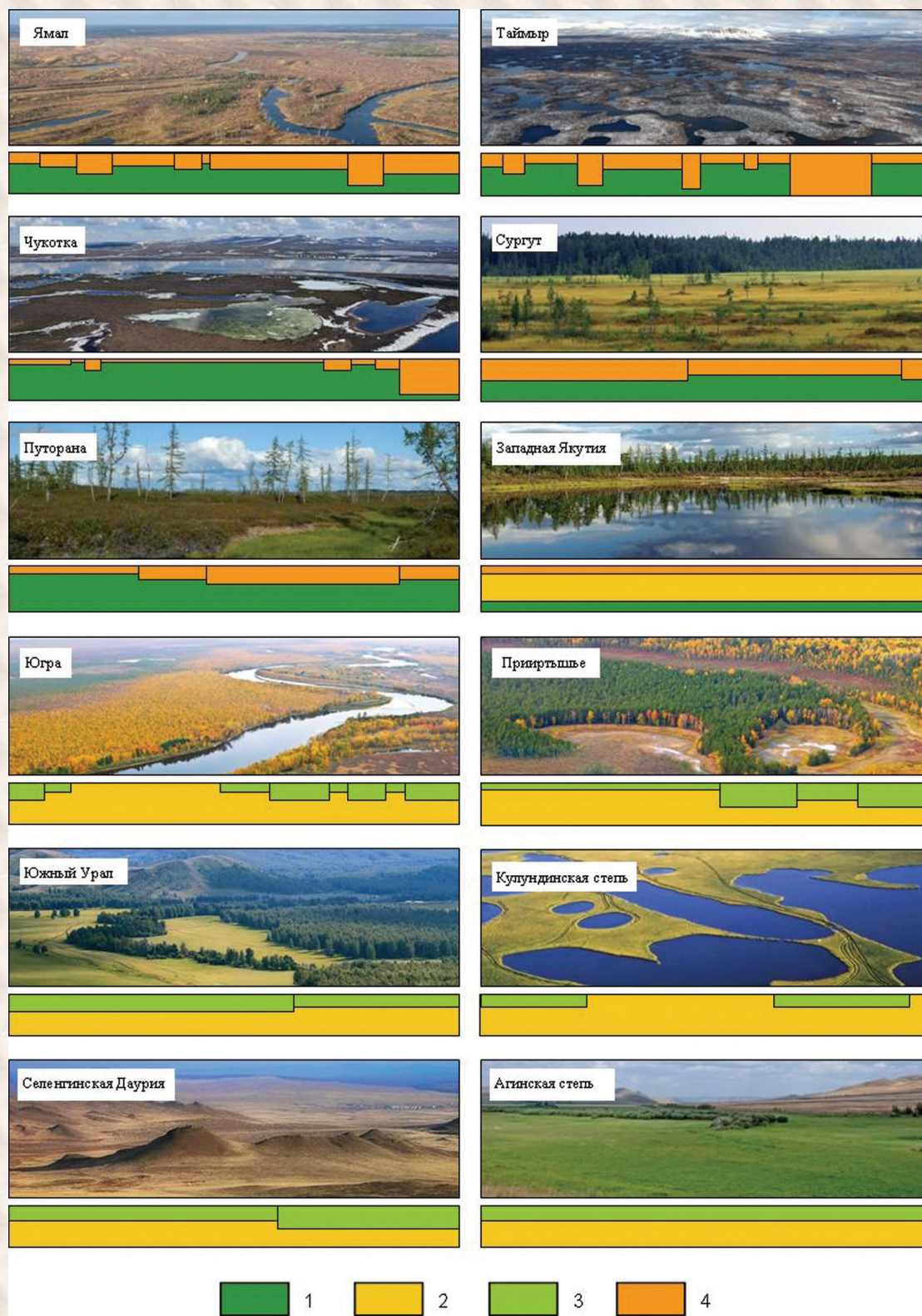
Рис. 4. Глубина сезонного протаивания и промерзания горных пород в зависимости от ландшафтных условий теплообмена в различных районах криолитозоны. Горные породы: 1 – многолетнемерзлые; 2 – талые и немерзлые; 3 – сезоннопротаивающие; 4 – сезоннопромерзающие. Мощность разреза – 2,5 м
