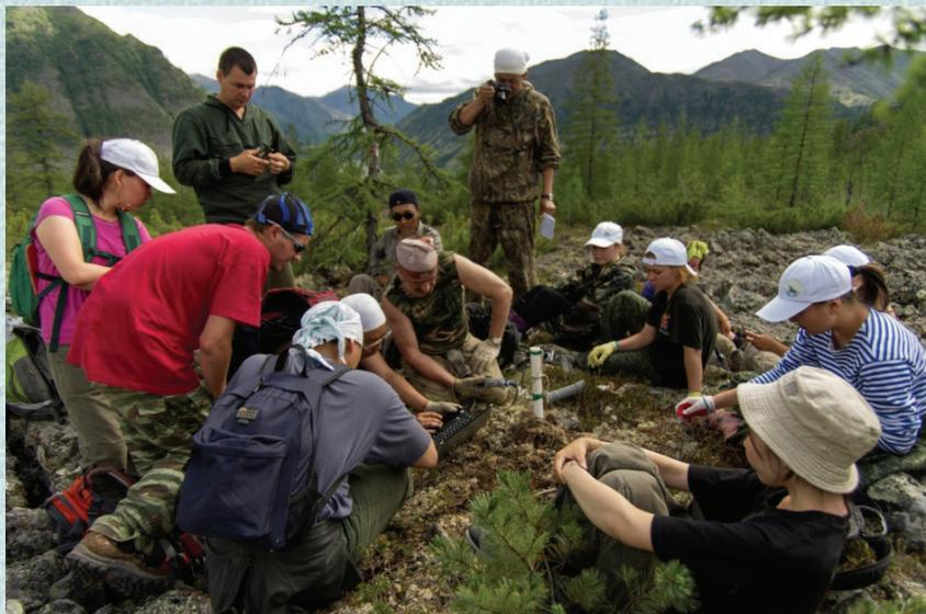
*Измерение температуры горных пород в скважине с помощью логгера*
