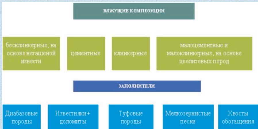
**Рис. 2. Разработанные варианты обеспечения подземных рудников закладочными смесями**
