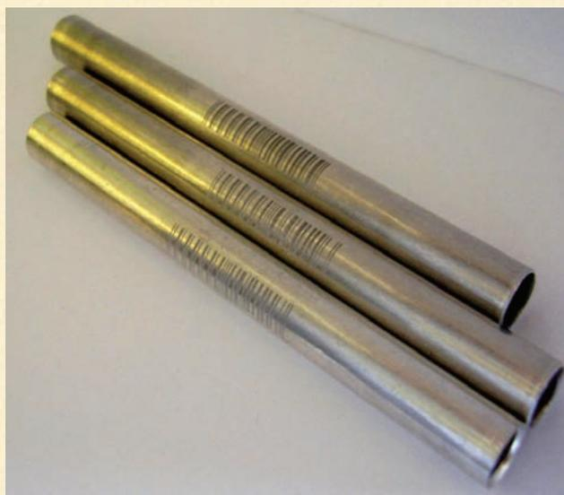
Лазерная маркировка металлических гильз детонаторов
