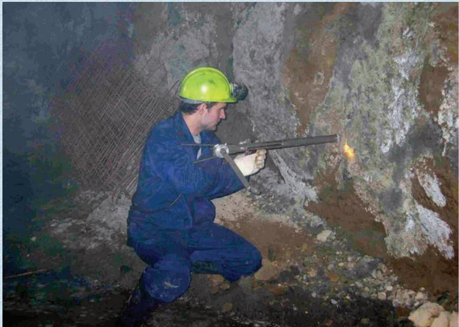
**Рис. 4. Испытание закладочного массива в условиях подземного рудника «Интернационального» с помощью прочностномера П-1**
