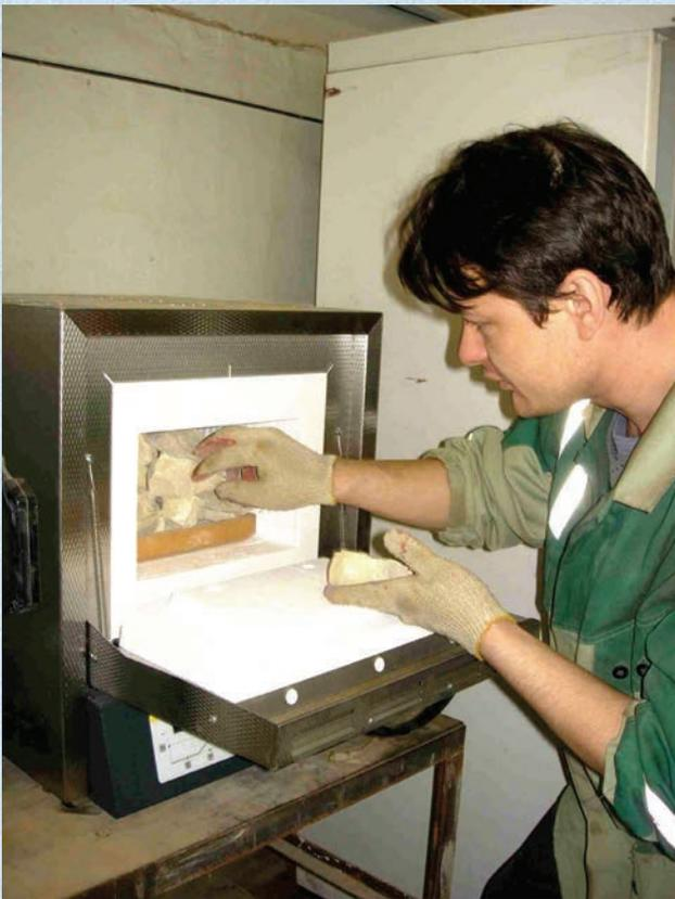
**Рис. 3. Загрузка известняка в печь обжига**
