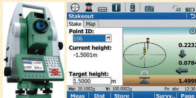
**Электронный тахеометр и рабочий экран его монитора**
