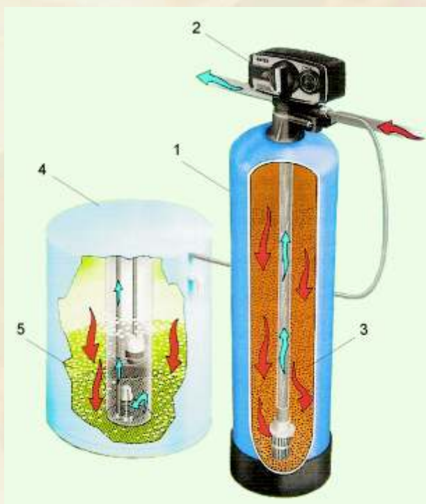
Рис. 3. Конструктивная схема фильтра ионного обмена.
