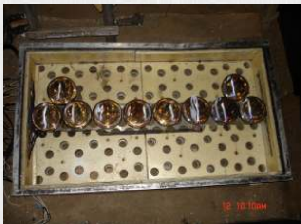
Рис. 5. Фотомозаика черенковского трекового детектора. Диаметр фотокатода 15 см.
