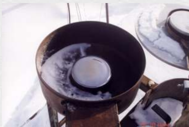
Рис. 4. Интегральный черенковский детектор, функционирующий на Якутской комплексной установке ШАЛ.
