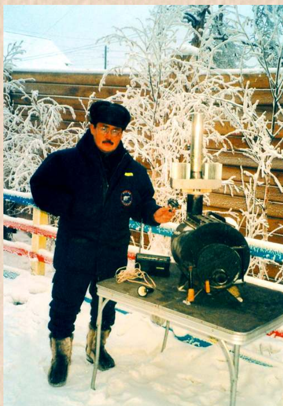
Рис. 2. Н.А. Находкин на испытаниях одного из первых вариантов термоэлектрогенератора «Чолбон».
