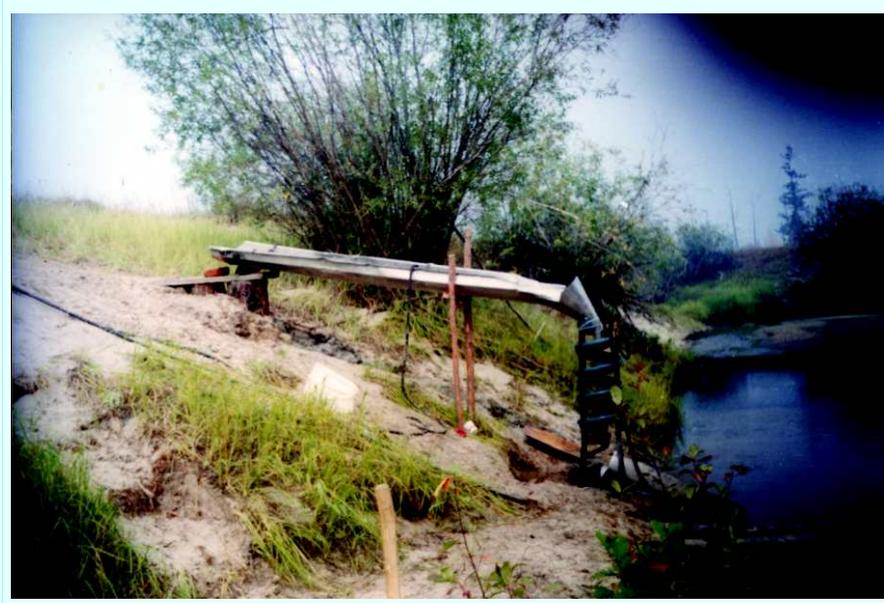
**Рис. 2. Сочетание «проходнушки» и винтового сепаратора, на котором намыты пиропы.**
