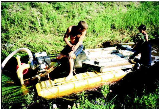
Испытание мини-драги на извлечение тонкого золота и платины в русле ручья.
