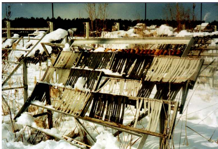
Рис.2. Экспонирование полимерных образцов на открытом полигоне.
