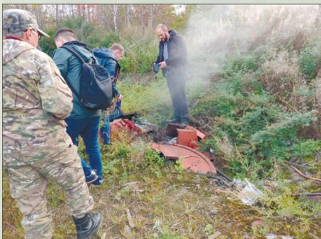
Рис. 3. Выход пирогенных газов и паров воды на дневную поверхность
