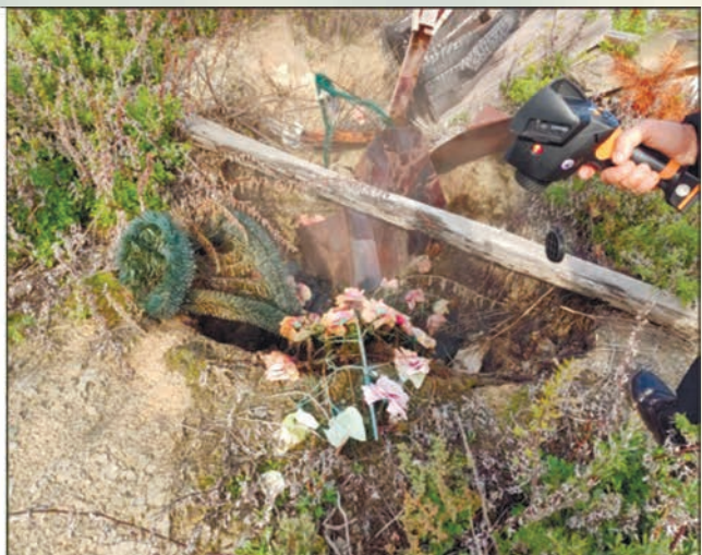
Рис. 2. Термические провалы на поселковом кладбище
