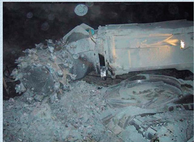
**Рис. 4. Характерный гранулометрический состав горной массы, отбитой комбайном**
