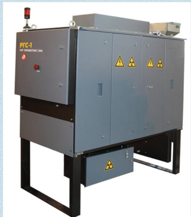
**Рис 5. Опытно-промышленный образец рентгенографического сепаратора для обогащения сухих алмазосодержащих концентратов класса -6+3 мм**
