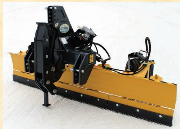
Навесной грейдер фирмы «STARK», эффективно используемый для очистки тротуаров ото льда и снега в Финляндии
