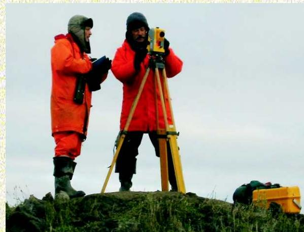
**Рис. 9. Съемка бровки и подошвы береговых уступов лазерным теодолитом. За прибором - директор Потсдамского филиала Института Альфреда Вегенера, проф. Х.-В. Хуббертен, слева - М.Н. Григорьев. Ойягосский Яр.**
