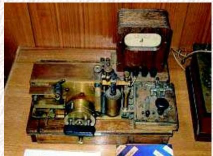
**Рис. 1. Аппарат Морзе первого серийного образца.**
