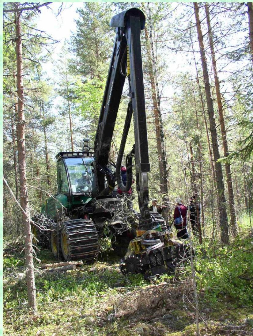
Рис. 3. Высокопроизводительная лесоповальная машина - харвестер.
