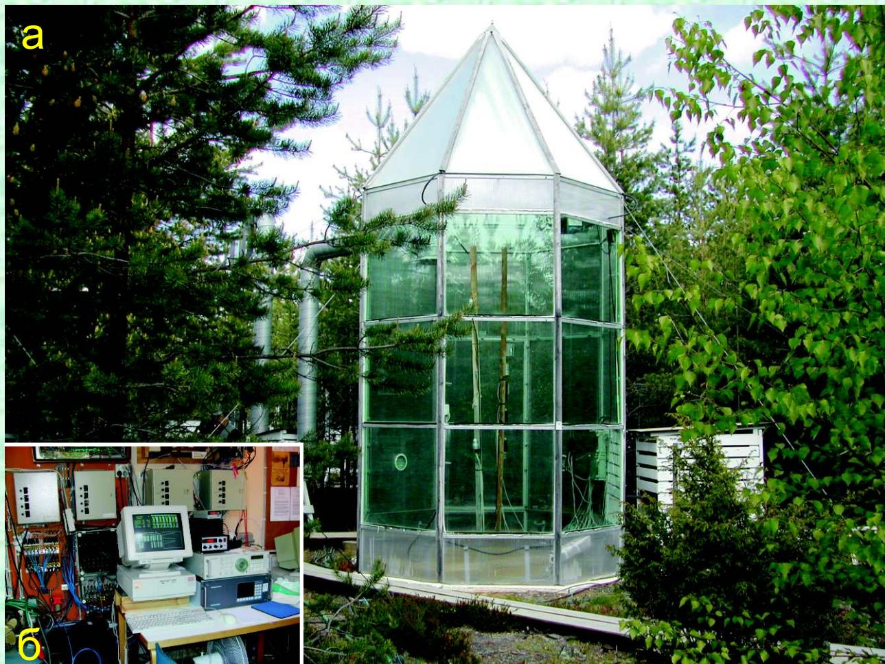
Рис. 2. В таких фитотронах моделируется влияние изменения состава воздуха на климат.
