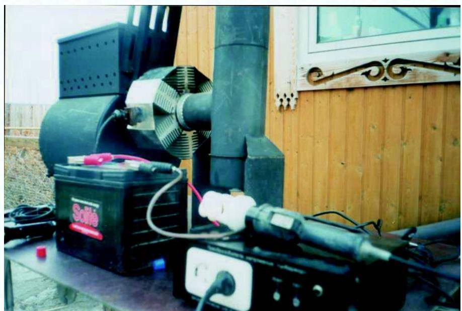
Рис. 4. Термоэлектрический генератор «Чолбон», преобразующий тепло обычной печки-буржуйки в электроэнергию. В комплекте с печью «Синель» он дает не только электричество, но и возможность выпекать хлеб, а также существенно экономит дрова.
