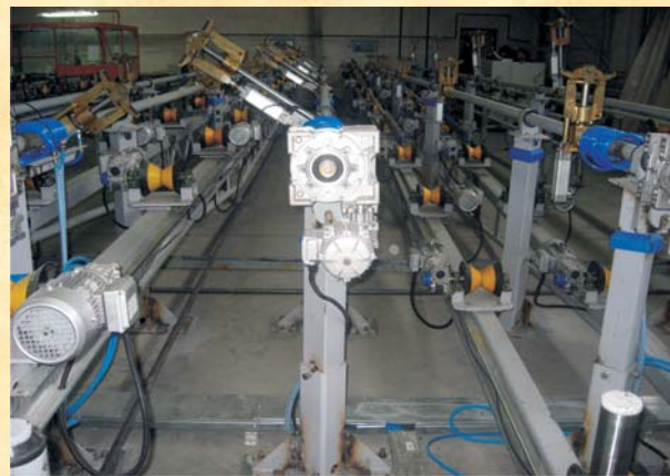
Автоматическая линия по заполнению термостабилизаторов хладагентом в производственном комплексе ООО НПО «Фундаментстройаркос» в пос. Матмасы. Фото автора.
