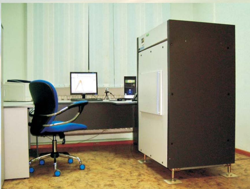
Рис. 5. Общий вид спектрометрического низкофонового радиометра Quantulus 1220 (лаборатория радиоуглеродного анализа Института мерзлотоведения им. П. И. Мельникова СО РАН, г. Якутск).
