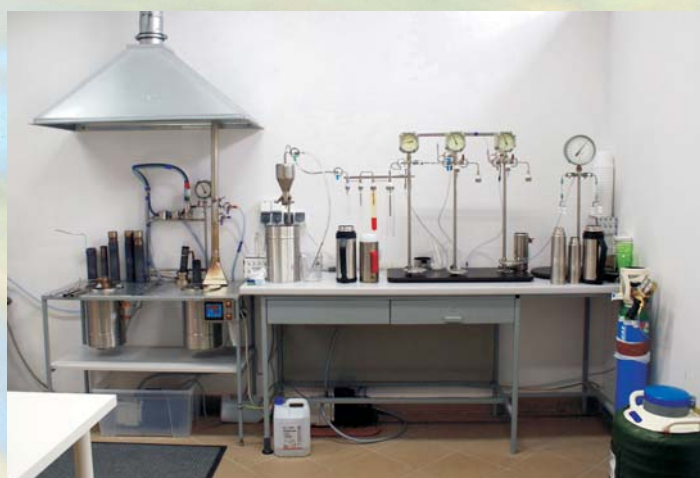
Рис. 3. Химическая лаборатория для получения бензола для установки Quantulus 1220 (ИМЗ СО РАН, г. Якутск).
