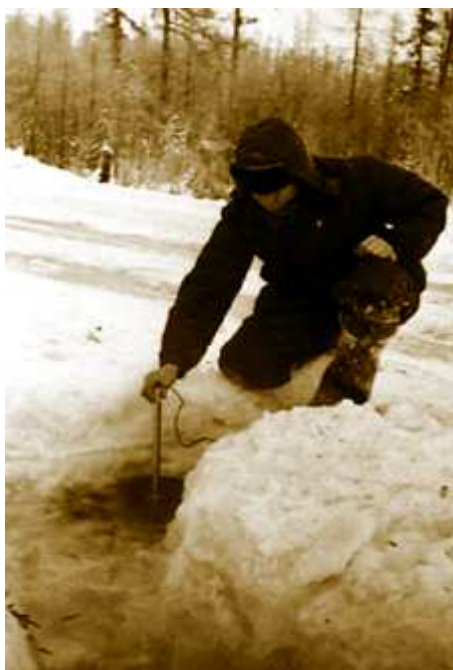
Измерение температуры воды наледобразующего источника родниковым термометром.
