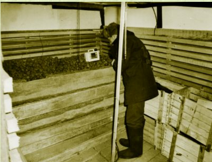
Рис. 4. Опытное подземное хранилище картофеля, сооруженное на территории Института мерзлотоведения СО РАН.
