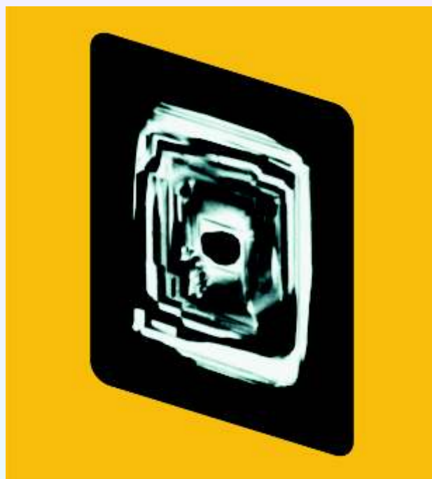
Рис. 2. Пластина алмаза (трубка «Удачная», увеличение 8), вырезанная из октаэдра по плоскости ромбододекаэдра (110).
