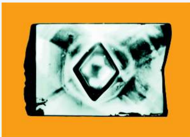
Рис. 3. Пластина алмаза (трубка «Удачная», увеличение 11), вырезанная по плоскости ромбодекаэдра (110) из кубического кристалла минералогической разновидности III.
